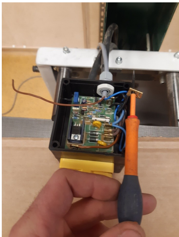
(Bild nr.10) Klipp av original flatstiftskontakten och sammankoppla kabeln med den andra ledaren i signalkabeln (WAGO 2:or funkar bra)
